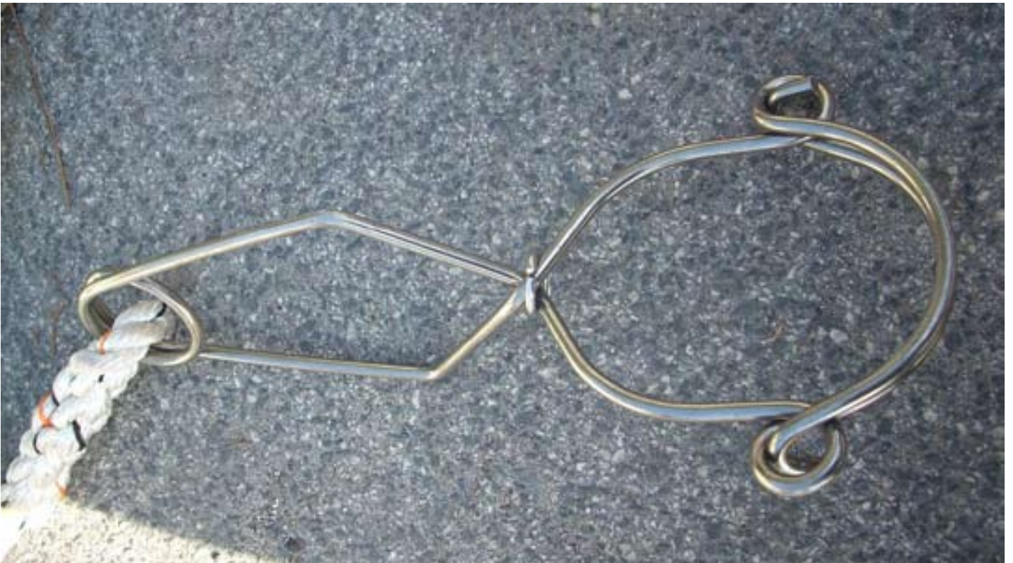
Fig. 6.2.9: Pinza da ponteggio. Si può connettere direttamente al ponteggio.
