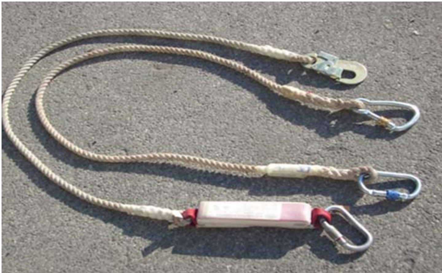
Fig. 7.2: All'interno cordino anticaduta con dissipatore di energia UNI EN 355, all'esterno cordino di trattenuta senza dissipatore di energia UNI EN 354.
