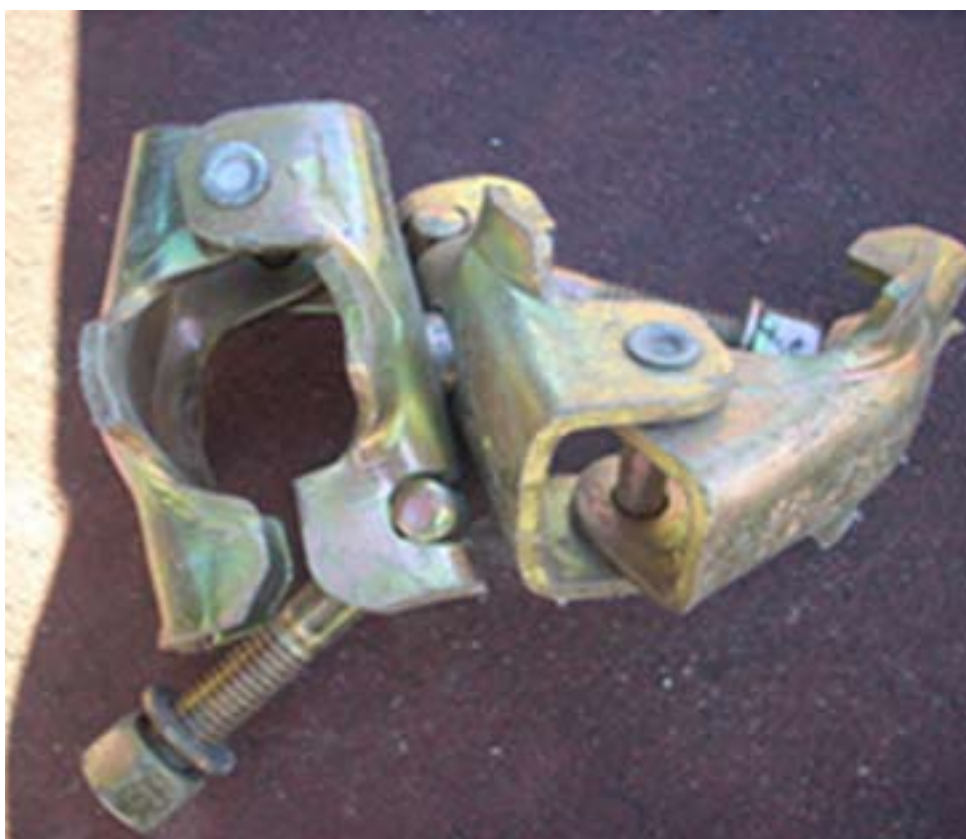
Fig. 2.2.4: Giunto girevole; si utilizza quando si devono unire tubi con angolo qualsiasi, come diagonali e raddoppi di montante.
