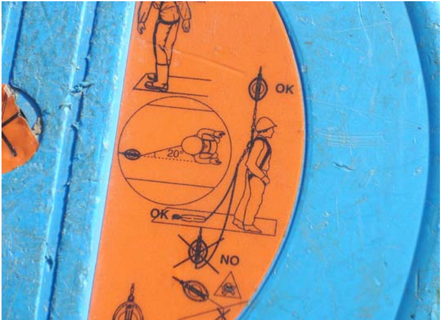
Fig. 6.2.15: La possibilità di utilizzare il dispositivo anticaduta retrattile in orizzontale, oltre che sul libretto di uso e manutenzione, viene indicata anche sul dispositivo stesso.
