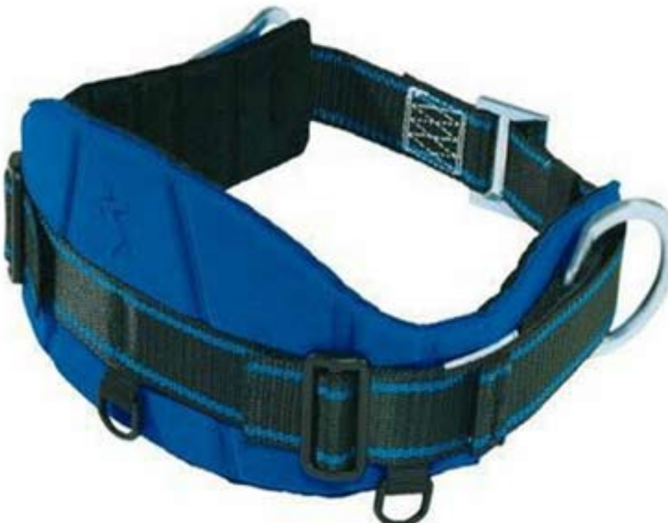
Fig. 7.5: Cintura di posizionamento UNI EN 358; i dispositivi di posizionamento possono essere utilizzati per arrestare una caduta solo nel caso in cui il dislivello di caduta non superi i 60 cm.; se utilizzati all'interno di un sistema di arresto di caduta conforme alla norma armonizzata UNI EN 363 devono essere abbinati a dispositivi anticaduta conformi a questa norma.
