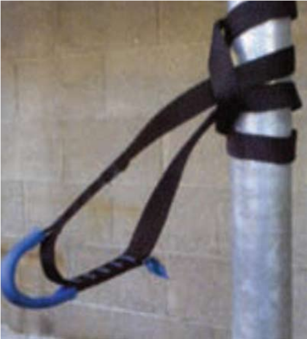
Fig. 6.2.17: Fettuccia tessile, dispositivo di ancoraggio UNI EN 795 classe B. La parte rinforzata in cui viene inserito il connettore collegato al dispositivo anticaduta, ha una resistenza di 1000 Kg. per un tempo di tre minuti. La lunghezza può essere 60, 80, 100, 120, 150, 200 cm.
