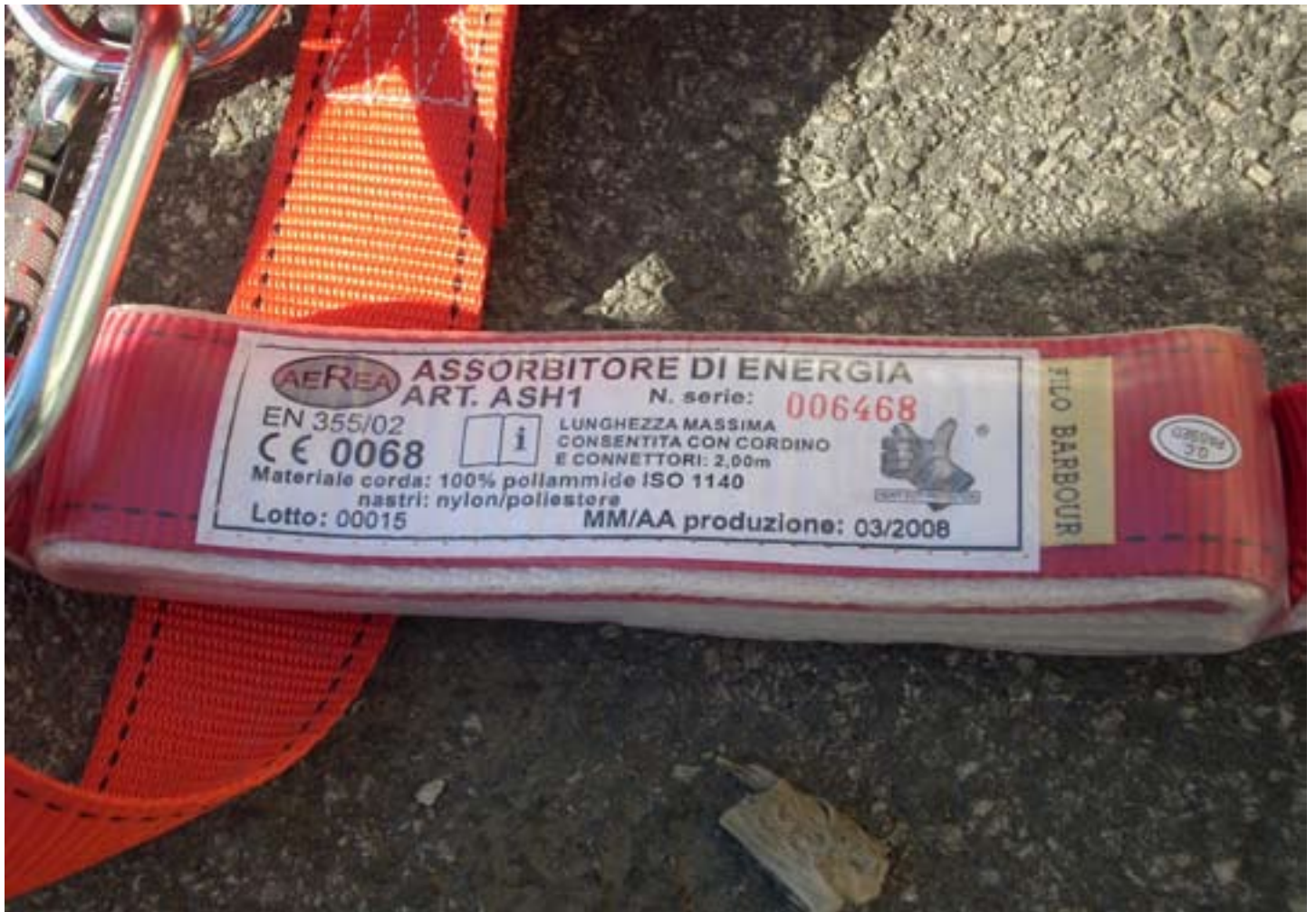
Fig. 6.2.11: Assorbitore di energia di un cordino anticaduta. In caso di caduta il dissipatore potrebbe aprirsi allo scopo di ammortizzare il colpo che il lavoratore subisce sul corpo. La lunghezza massima del cordino può essere 2 metri, compresi i connettori.
